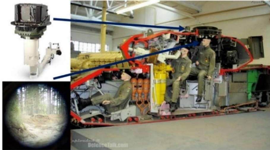
98. ábra: Parancsnoki figyelőműszer és látómező
